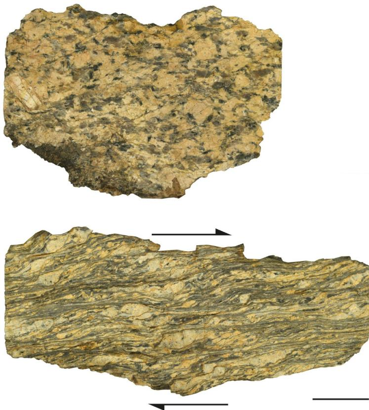
**Figure 8. Granite de Parthenay.** Roche non déformée [en h.] et roche déformée (= mylonite) par cisaillement le long de la faille de Parthenay [en b.] (échelle : 25 mm).
