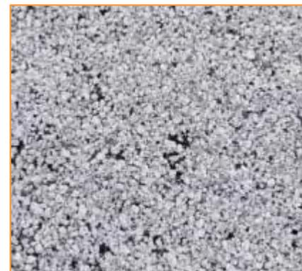
Aperçu détaillé de béton poreux
