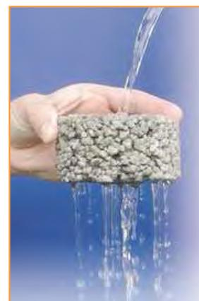
Perméabilité d'un béton poreux
