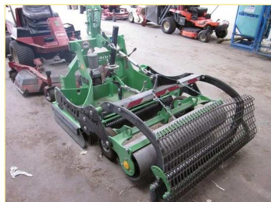
Engin de nettoyage pour les sables stabilisés
