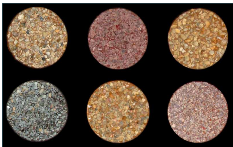
Aperçus détaillés de différentes teintes d'enrobé pouvant être obtenues avec un liant clair (liste non exhaustive)
