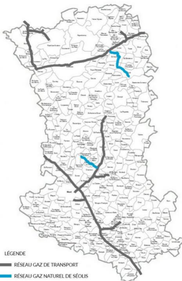
Figure 70 : Réseau de transport de gaz et réseau de distribution de gaz de Séolis 21
