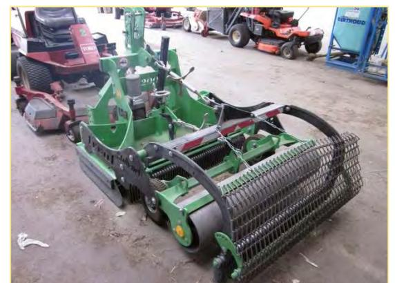
Engin de nettoyage pour les sables stabilisés
