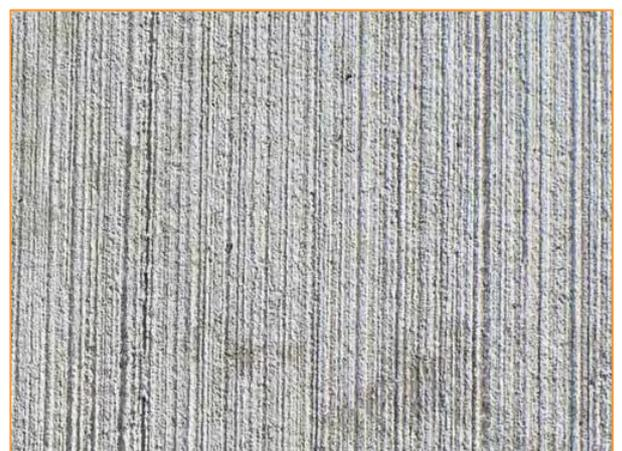
Aperçu détaillé – Béton balayé
