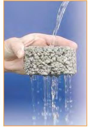
Perméabilité d'un béton poreux
